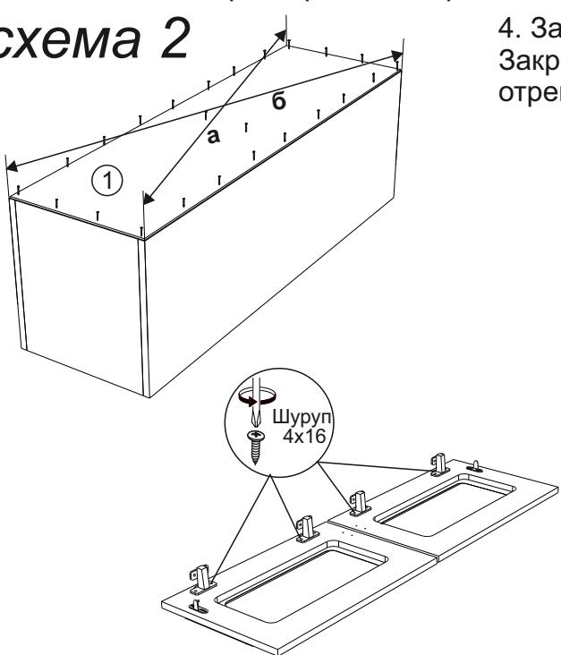
4. Закрепите петли к створкам №5 с помощью шурупов 4x16. Закрепите створки к ответным планкам петель на крышке, отрегулируйте и выставьте зазоры. Установите газ-лифты.
