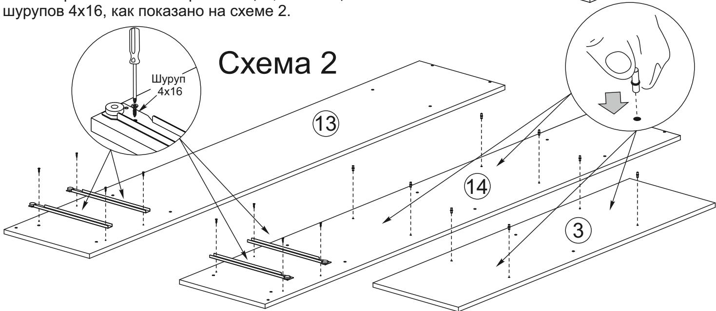
4. Соедините между собой боковины №13 и №14 с вязками №4, №15 и цоколем №12 с помощью евровинтов. Затем между вязками №4 установите перегородку №3 и закрепите ее евровинтами.
