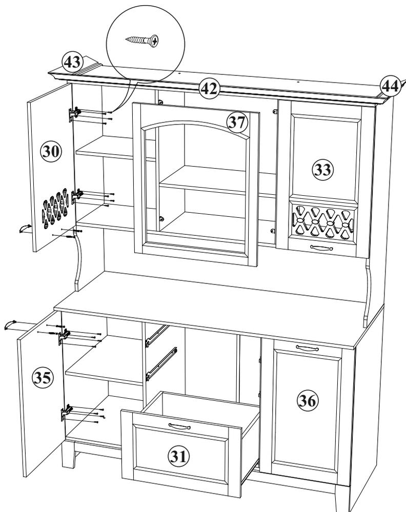
Регулирование зазоров и положения дверей с петлями
