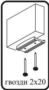
схема крепления угловой стяжки
