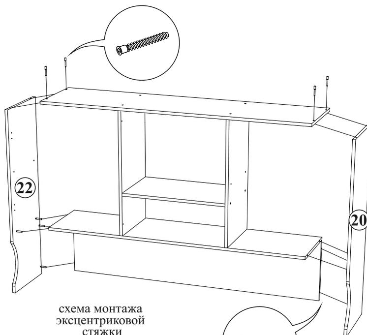
схема монтажа эксцентриковой стяжки
