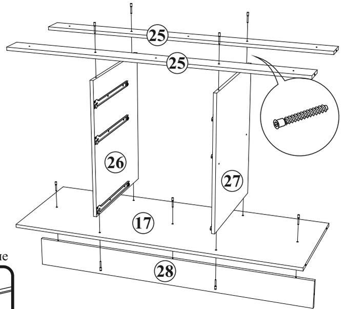
схема крепления панелей евроинтом
