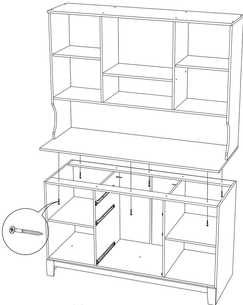
13. Соединить собранные каркасы шурупами 4x30.
