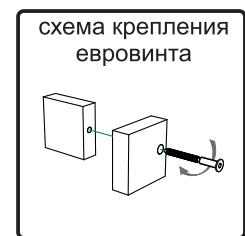
3. Соединить боковины 4, 5 и перегородку 2 с крышкой 6, используя евровинты, предварительно вставив задние стенки 1 в соответствующие пазы.
