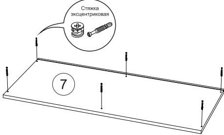
3. На крышки 6 и 7 установить штоки эксцентриковых стяжек.
