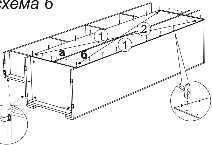
8. Присоедините с помощью евровинтов крышки №10 и №14 к боковинам №11, 15, 17 и 18, вставьте в соответствующие отверстия эксцентриковые стяжки и шканты на деталях № 10, 11, 14, 15, 18. Вверните штока эксцентриковых стяжек в планки МДФ №21, №23 и №24, как показано на схеме 7.
