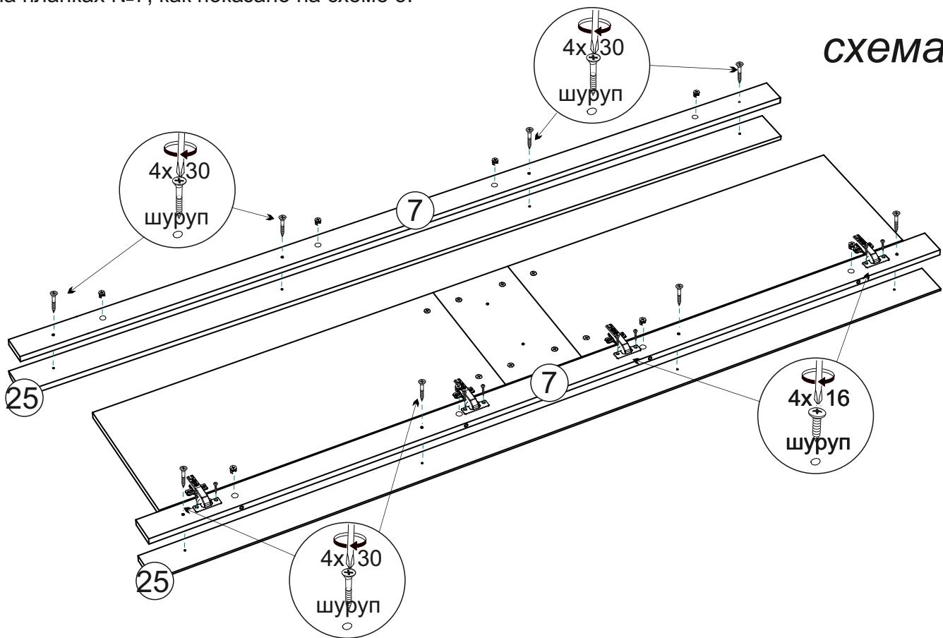
7. Установите собранные створки с планками на боковины шкафа, вставив заранее ввернутые боковины штока эксцентриков в соответствующие отверстия на планках №7 а затем затянув эксцентриковые стяжки. Чтобы установить задние стенки (ЛДВП) №1, необходимо собранную
