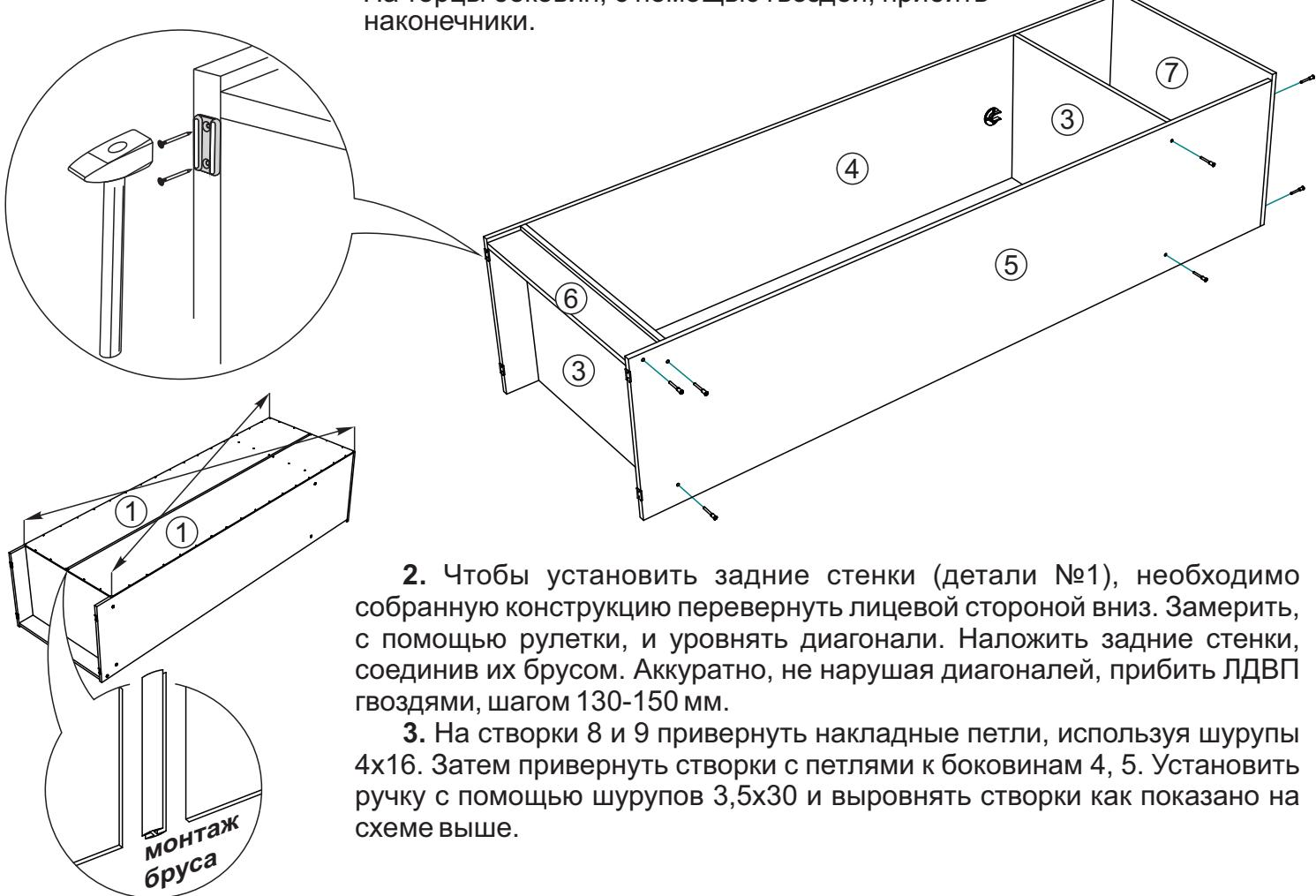
2. Чтобы установить задние стенки (детали №1), необходимо собранную конструкцию перевернуть лицевой стороной вниз. Замерить, с помощью рулетки, и уравнять диагонали. Наложить задние стенки, соединив их бруском. Аккуратно, не нарушая диагоналей, прибить ЛДВП гвоздями, шагом 130-150 мм.
