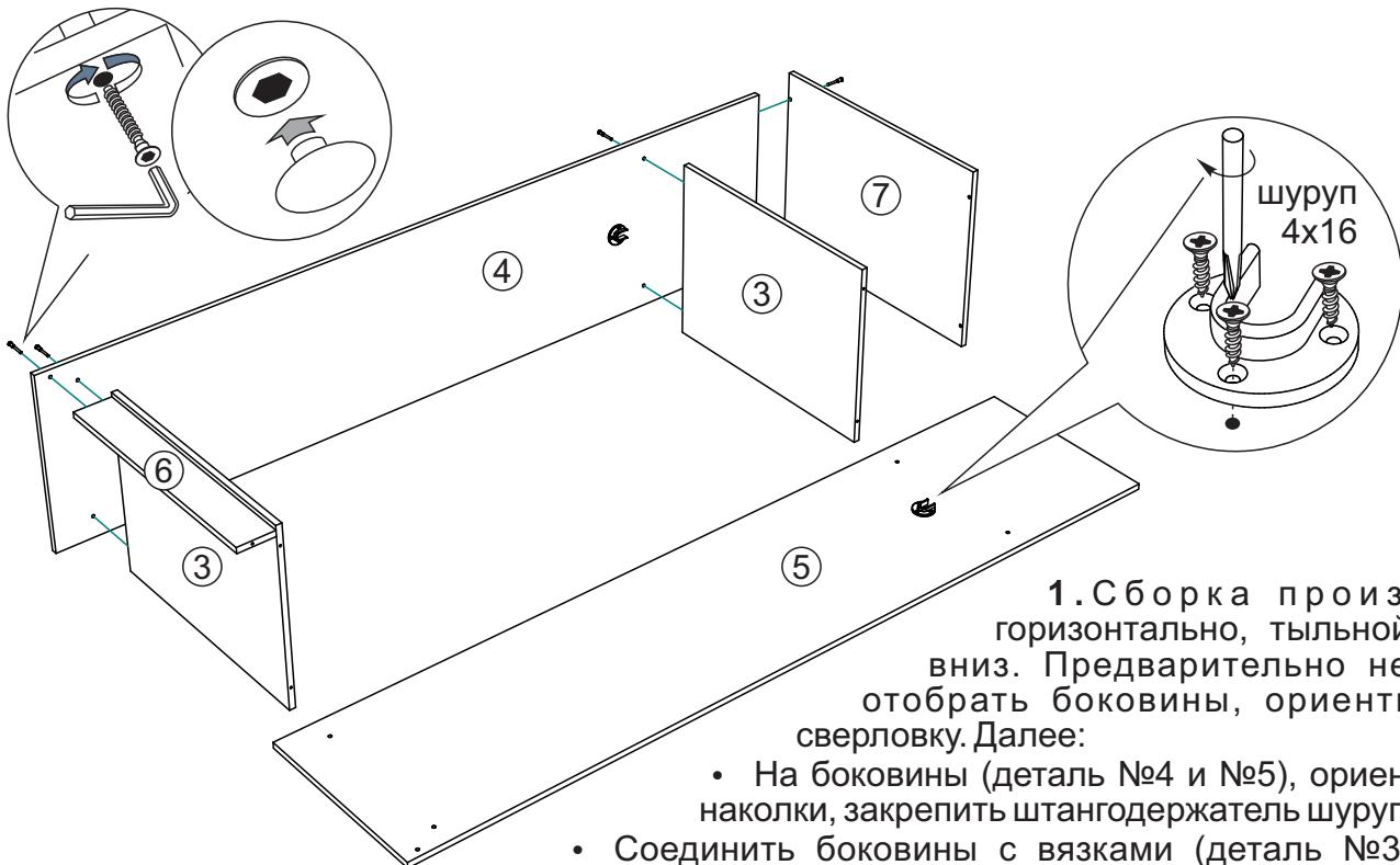
1. Сборка производится горизонтально, тыльной стороной вниз. Предварительно необходимо отобрать боковины, ориентируясь на сверловку. Далее:
