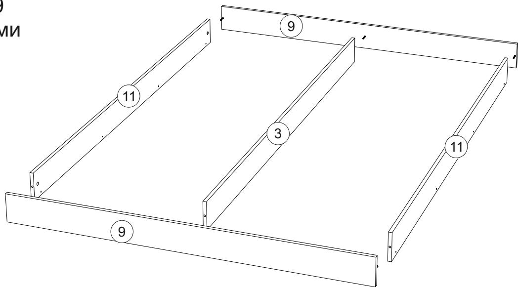
6. Соединить собранные цоколи с каркасом, используя шурупы 4x30.
