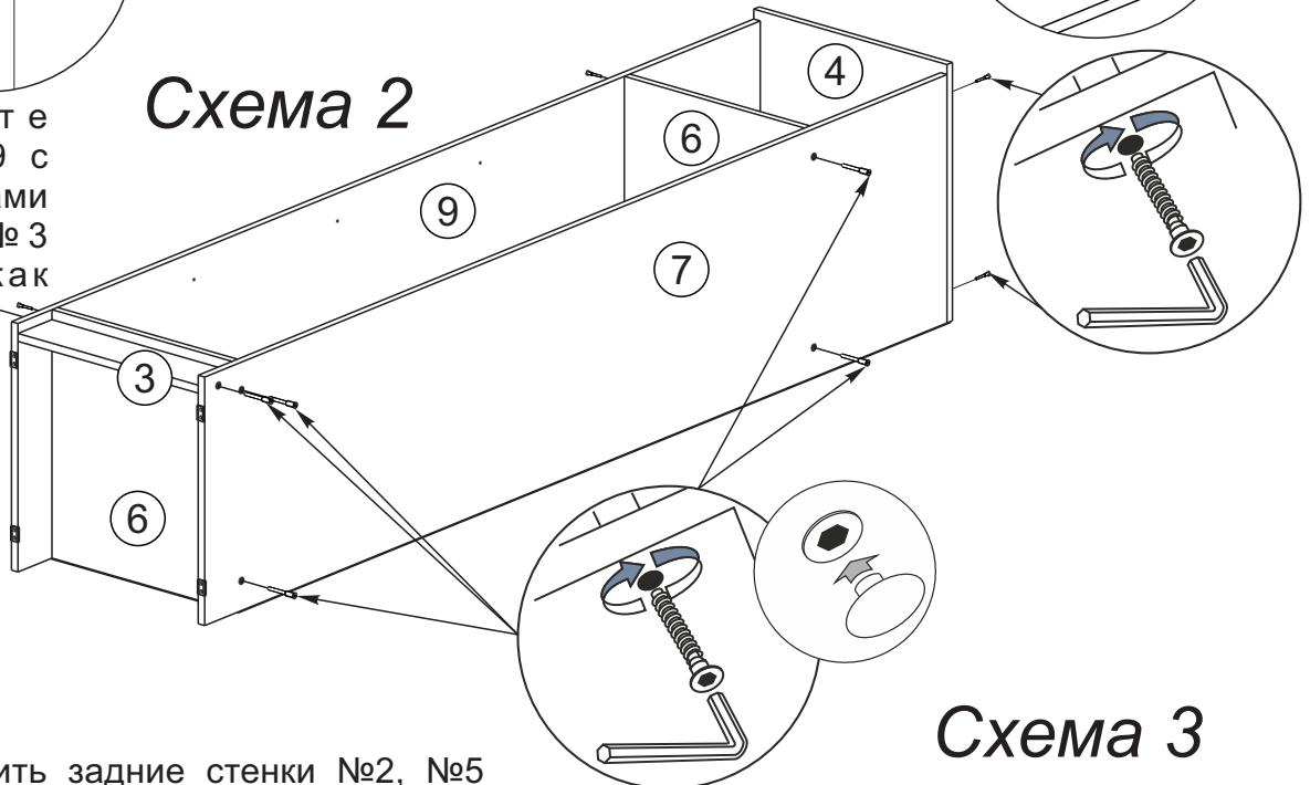
3. Чтобы установить задние стенки №2, №5 необходимо собранную конструкцию перевернуть лицевой стороной вниз. Замерить, с помощью рулетки, и уровнять диагонали. Наложить задние стенки, соединив их с помощью монтажного бруса. Аккуратно, не нарушая диагоналей прибить ЛДВП с шагом 130-150мм. гвоздями согласно схеме 3.
