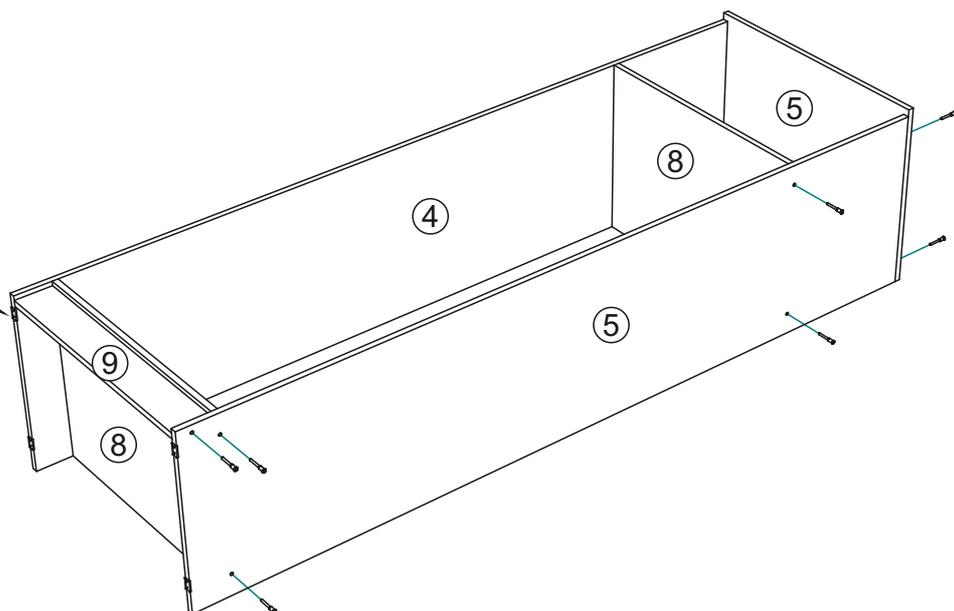
2. Чтобы установить заднюю стенку (деталь №2), необходимо собранную конструкцию перевернуть лицевой стороной вниз. Замерить, с помощью рулетки, и уровнять диагонали. Наложить заднюю стенку. Аккуратно, не нарушая диагоналей, прибить ЛДВП гвоздями, шагом 130-150 мм.
