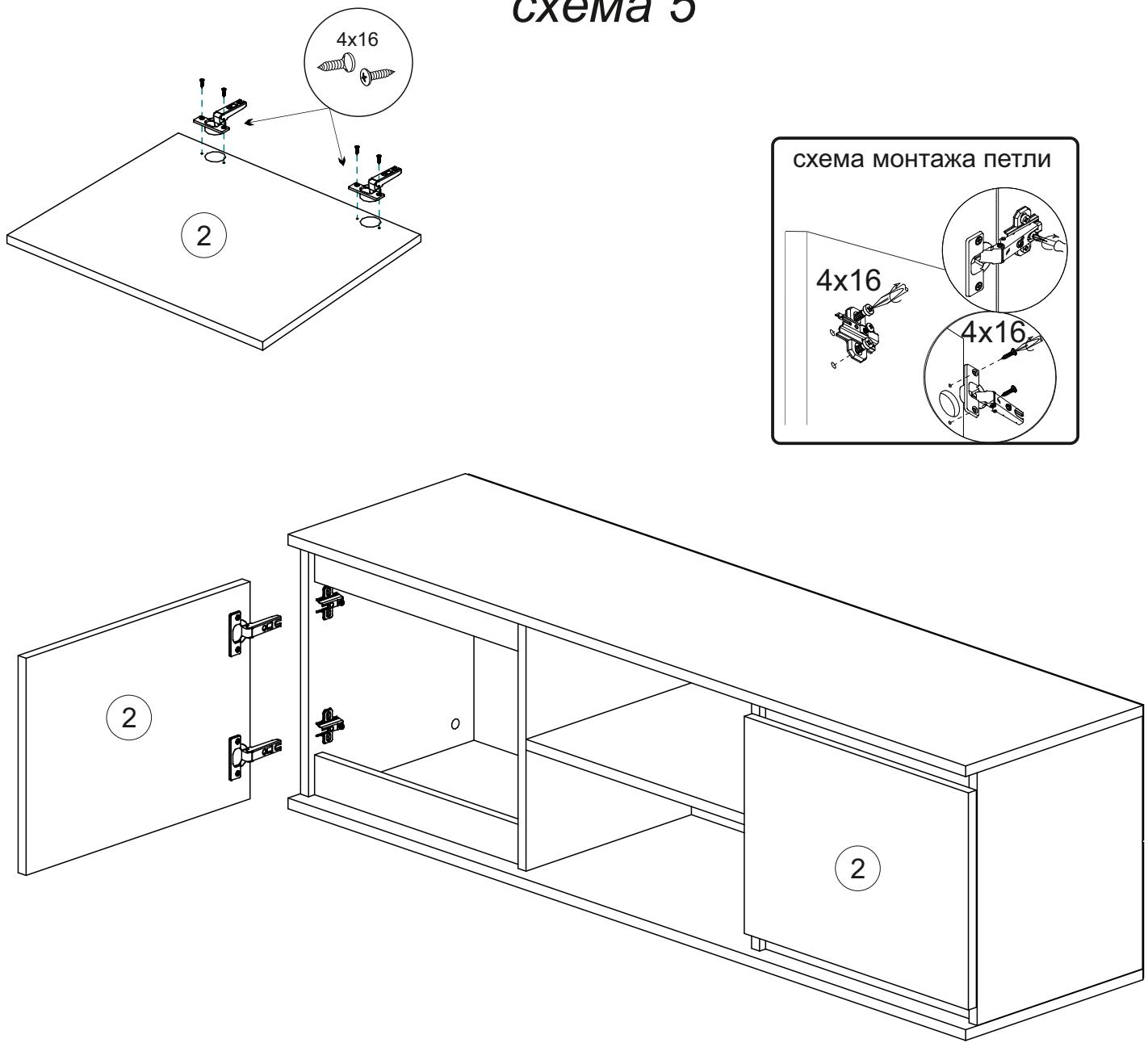
Регулирование зазоров и положения дверей с петлями
