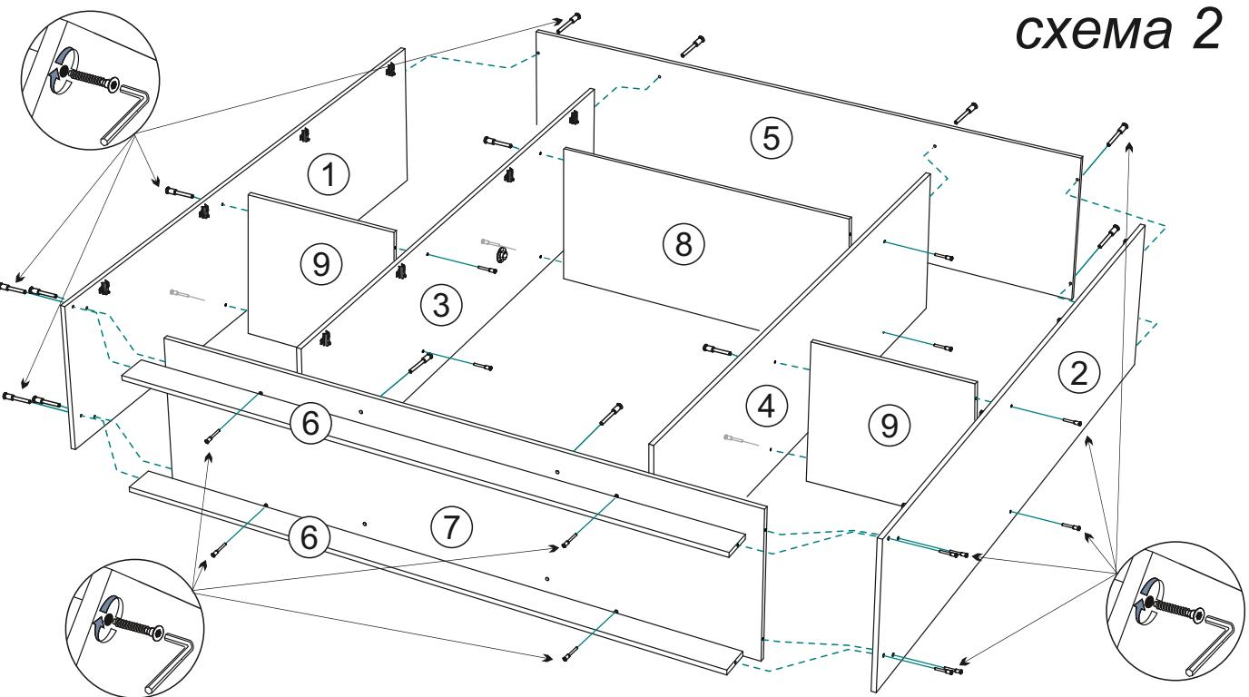
4. Чтобы установить задние стенки (детали №15, №16), необходимо сбранную конструкцию перевернуть лицевой стороной вниз. Замерить, с помощью рулетки, и уравнять диагонали ( $a=b$ ). Наложить задние стенки предварительно соединив №16 бруском для ЛДВП №18 и аккуратно, не нарушая диагоналей, прибить ЛДВП гвоздями, с шагом 130-150 мм, затем также гвоздями прибейте подпятники на боковины и цоколя, (схема 3).
