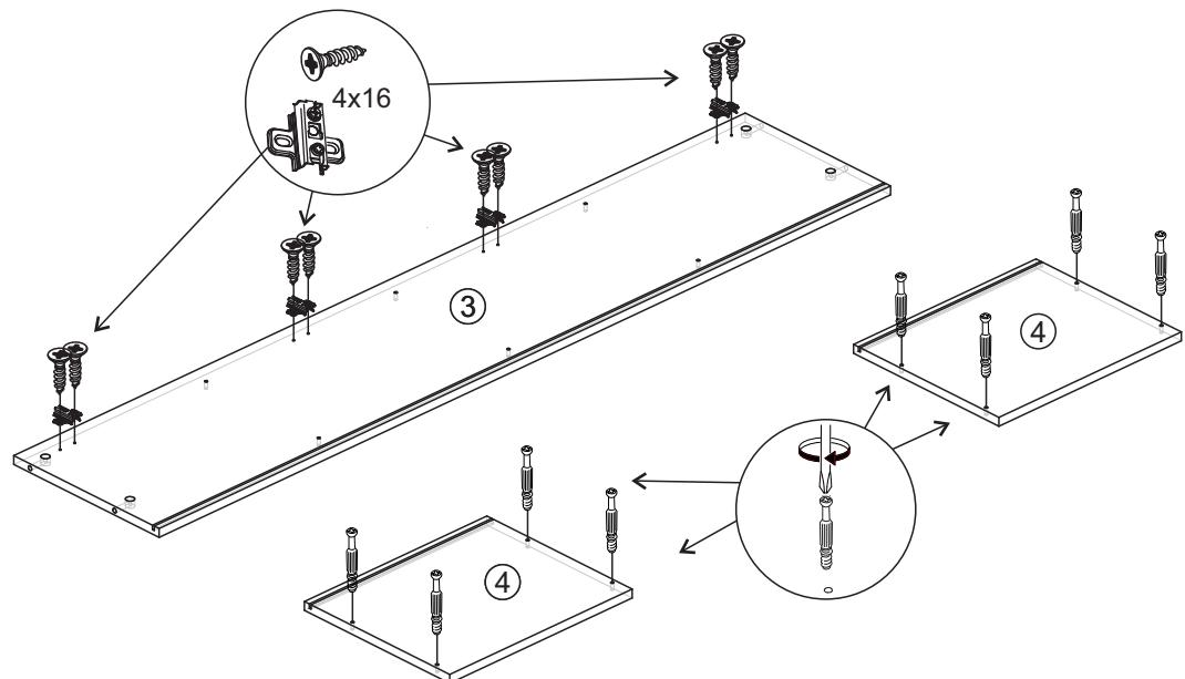
3. Закрепите с помощью эксцентриковых стяжек к нижней крышке №4 боковины №3, затем вставьте в паз заднюю стенку №1 (ЛХДФ) предварительно прорезав отверстия для регулируемых навесов.
