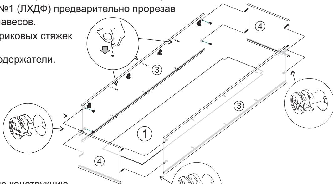
4. Переверните собранную конструкцию лицевой стороной вниз, уравняйте диагонали а=б и аккуратно не нарушая диагоналей закрепите заднюю стенку №1 к боковинам и крышкам с помощью уголков RV8 и шурупов 4x16.
